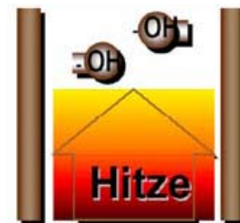
Teilweise Auflösung der Hydroxylgruppen durch Hitzeeinwirkung
