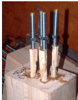
Ausreißen der Stangen inklusive eines Teils des umgebenden Holzes
