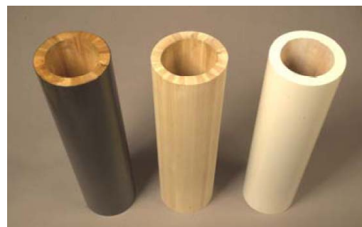
Rohrquerschnitte mit textiler Bewehrung, links Kohlefaser, Mitte unbewehrt, rechts Glasfaser, lackiert
