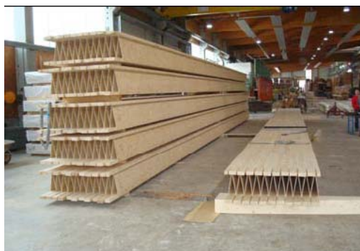
Die Darstellung zeigt vorgefertigte Kielstegelemente in der Produktionshalle
