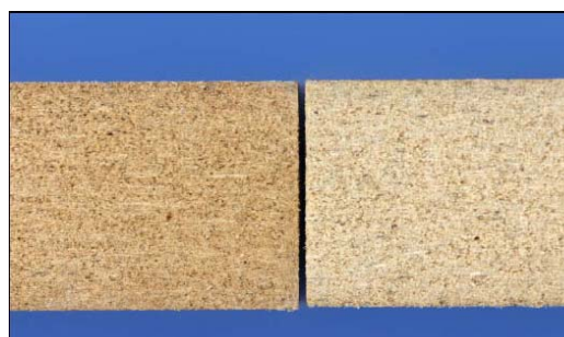
Faserplatten mit besonderer Behandlung der Fasern vor (rechts) und nach (links) extremer klimatischer Beanspruchung [WKI]
