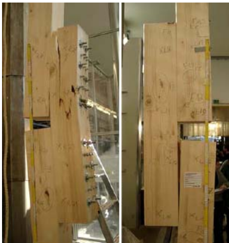
Bruchzustände eines konventionell mit Stabdübeln und eines mit Vollgewindeschrauben gefügten einseitigen Zuglaschenstoßes
