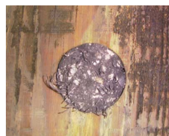
Typisches Versagensbild der Blockscherversuche (P2-50)
