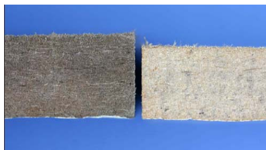
Faserplatten des Typs HB.HLA2 vor (rechts) und nach (links) extremer klimatischer Beanspruchung [WKI]
