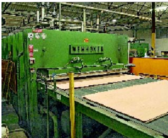
Deutsche Maschinenteknik wird natürlich auch in Spanien häufig verwendet. Hier ist eine Furnierpresse des ostwestfälischen Anlagenherstellers Wernhörer, Herford, bei Camasa im Einsatz.
