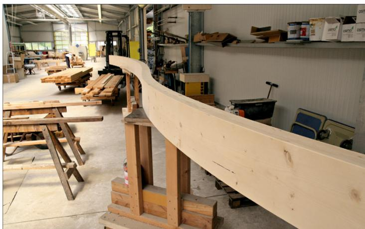
Vor dem Abbund: Seine Krümmung in Längsachse erhielt das Holz bereits im Brettschichtholz-Werk.
