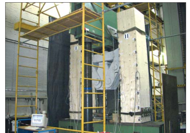
Belastungsversuch an der MPA Stuttgart mit einem der großen Fachwerkknoten.
