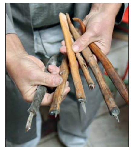
Die Furniermesser sind eigens gefertigt und an die zeitaufwändige Handarbeit optimal angepasst.
