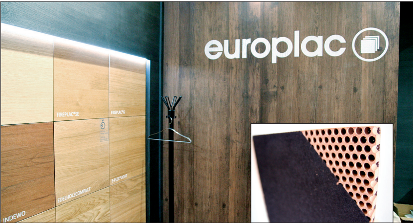
Akustisch „aktive“ Wand auf dem Messestand der Firma Europlac: Die Furniere der Akustikelemente sind mikroperforiert, sodass sie als Schallschutzelemente kaum erkennbar sind. Das kleine Bild zeigt die Rückseite eines Akustikelements, auf dessen gelocherte MDF-Träger ein akustisch wirksames Vlies aufgeklebt ist.
