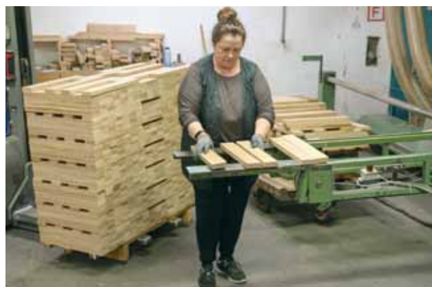
Bild links: Hier lagern die Friese vor der Trocknung: Laubhölzer aus der Region, Eichen aus Frankreich und zu einem kleinen Teil Hölzer aus Nordamerika und den Tropen – alles mit Herkunftszertifikat. Bild rechts: Die optische Beurteilung der rohen, getrockneten Parkettstäbe (Friese) ist für die künftige Sichtqualität der Vollholzböden von zentraler Bedeutung.
