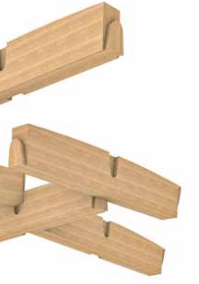
Das Tragwerk in Annweiler zeichnet sich durch eine hohe Materialeffizienz aus in Form von kurzen Stäben und Schwalbenschwanz-Verbindungen (Holz-Holz-Verbindungen), die lediglich einige Schrauben zur Lagesicherung benötigen.
