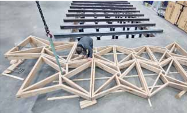
Vorfertigung von Segmenten des Friedberger Tragwerks: Mehrere Hexagone, die durch kurze Stäbe aus Kastanienvollholz gebildet werden.
