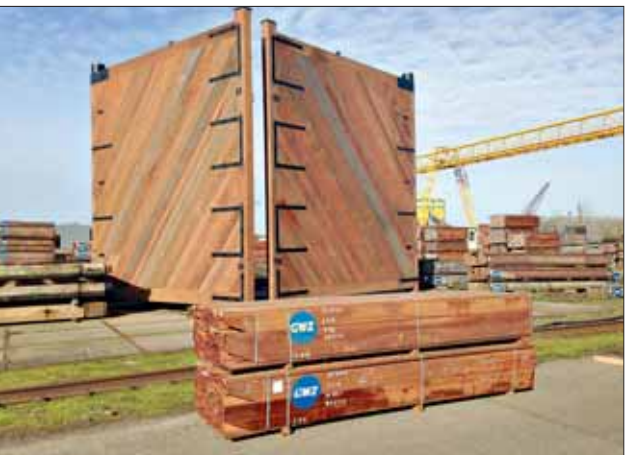
Schleusentore (hier für eine Schleuse in Gorinchem, Niederlande) werden bei Hupkes Wijma bis zu einer Höhe von maximal 12 m produziert.
