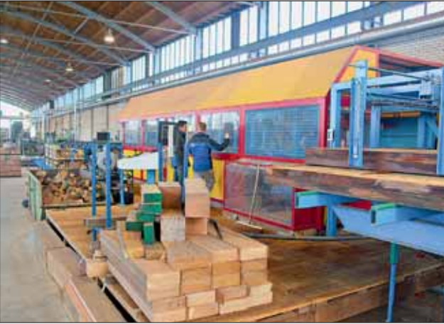
Die Hundegger „K2i“ zeigt, dass auch tropische Hölzer mit herkömmlichen Abbundanlagen bearbeitet werden können. Voraussetzung: besonders gehärtete Werkzeuge. Denn die Rohdichte z. B. von Bongossi macht im luftgetrockneten Zustand 950 kg/m³ bis über 1.300 kg/m³ aus, und einige Tropenhölzer enthalten Silikate, die die Standzeit deutlich verkürzen. Rechts: Die Montage einer Holzbrücke. Die Verbindungen erfolgen nur über Stahlbeschläge und Schrauben. Fotos (3): S. Klein
