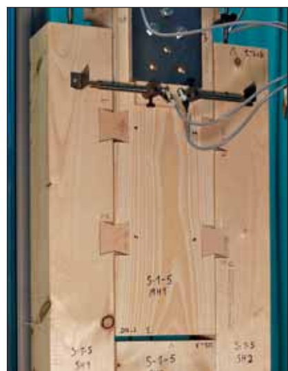
Im Projekt „Klebstofffreies Balkenschichtholz“ wurden CNC-gefertigte Holz-Holz-Verbindungen auf ihr Trag- und Verformungsverhalten unter Berücksichtigung von Fertigungstoleranzen geprüft. Foto: FH Aachen/AZH
