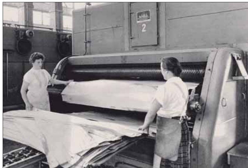
Was hier aussieht wie eine Wäschemangel, ist ein Furniertrockner.
