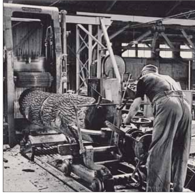
Optimale Stammausbeute per Augenmaß
