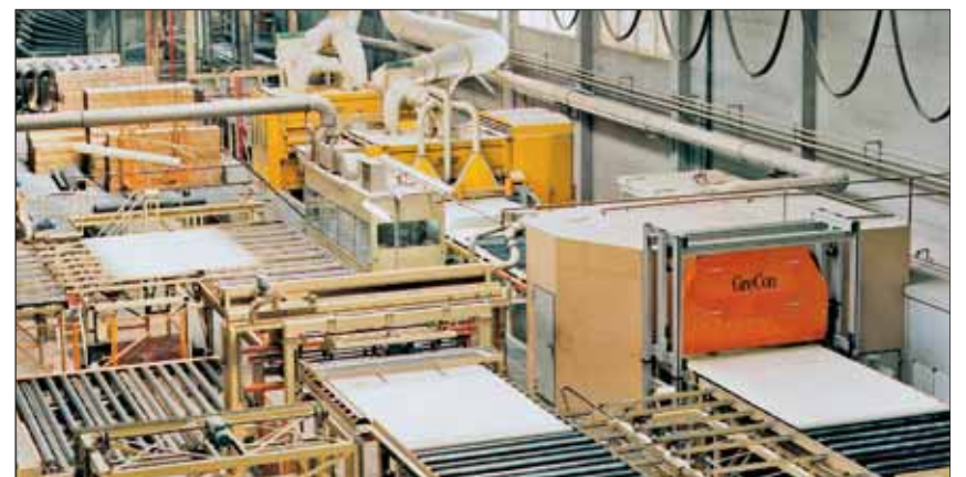
Ein „Superscan“-System in der Produktionskette eines Plattenwerks aus dem Jahr 1996. Während viele Produktionslinien heutzutage linienförmig verlaufen, wird diese Produktion fließend ausgerichtet – die Produktionsbereiche laufen parallel.
