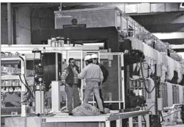
Rege Diskussion: Grecon-Mitarbeiter bei der Installation eines Messsystems in einer kontinuierlichen Pressenlinie des Eppinger Herstellers Dieffenbacher
