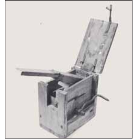
Mit diesem Holzschleifapparat von 1843 wurden Holzformen für die Papierherstellung produziert.
