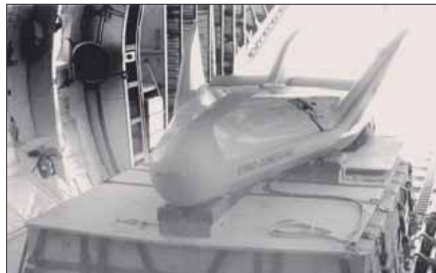
Mit dem Raumgleiter zu den Sternen – Versuchsmodell aus Holz und Holzwerkstoffen anno 1971.
