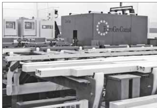
Der „Euro-Grecomat“ ermöglichte nicht nur die maschinelle Sortierung mithilfe des Röntgenverfahrens, sondern wird auch die Kappsäge an, Schwachstellen herauszuschneiden.
