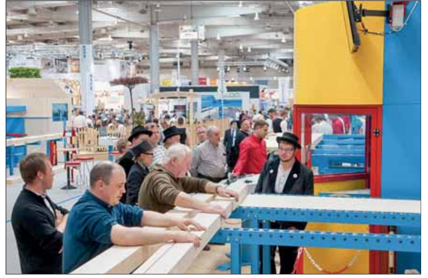
In den 2010er-Jahren gewinnen die Vorfertigungsprozesse im Holzbau an Bedeutung (hier eine Hundegger Abbundanlage).
