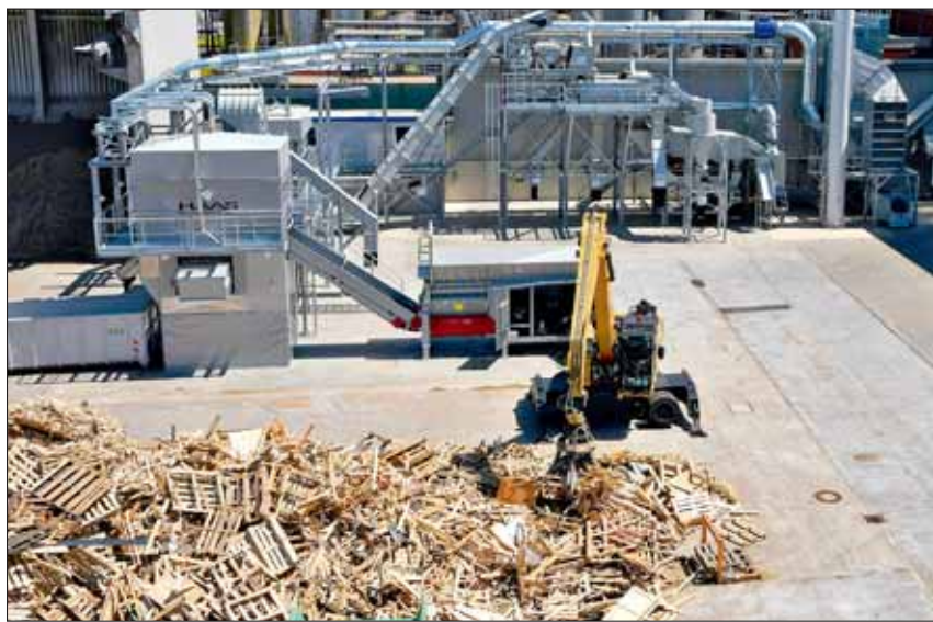
Ziel der Aufbereitung ist es, aus Holzabfällen einen industriell verwertbaren Sekundärrohstoff herzustellen. Foto: AVG
