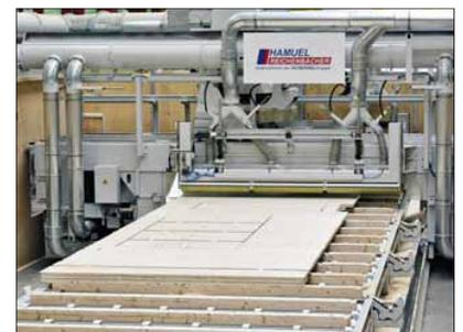
Drei baugleiche und parallel angeordnete Portalanlagen übernehmen den Abbund der Bauteile, wobei ein fünfschichtiger Werkzeugkopf zum Einsatz kommt.
