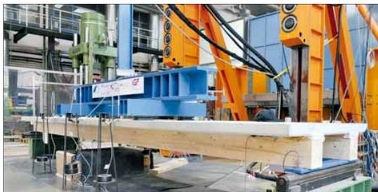
Die Prüfung im Aufspannfeld zeigt: Durch die neue Schnellklebtechnik lassen sich tragfähige Holz-Beton-Verbundelemente mit großen Spannweiten – hier im Bild mit 6,15 m – sicher herstellen. Fotos: Universität Kassel/Jens Frohmüller
