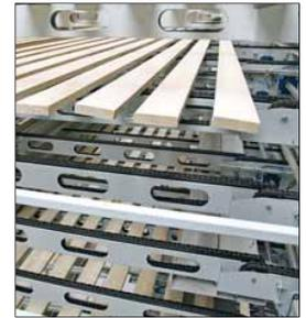
Die keilgezinkten und auf Länge gebrachten Einzelamellen härten in einem sechsstöckigen Etagenlager aus, bevor sie chargenweise (Brettlage für Brettlage) flächenverleimt werden.
