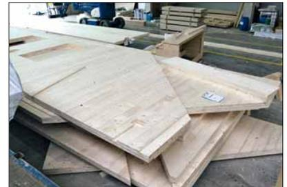
Die Größe der Produktionschargen richtet sich nach den zu beladenden LKW, während die Reihenfolge innerhalb einer Produktionscharge der Verladereihenfolge auf dem LKW respektive der Montagerihenfolge auf der Baustelle folgt.
