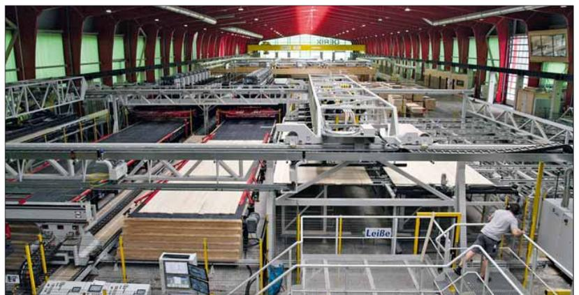
Die flächenverleimten Brettlagen eines BSP-Elements, der sogenannte Presskuchen, vor dem Einlauf in die hydraulische BSP-Pressen, wo es unter hohem Druck (0,6 N/mm<sup>2</sup>) aushärtet.
