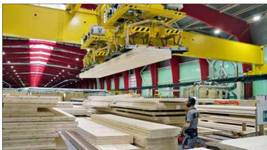
Einem Goliath unter den Hallenkränen gleich kommt der neue Portalkran, der mit einer Spannweite von 42,5 m nahezu die gesamte Halle auf einer Länge von 220 m durchfahren kann.
