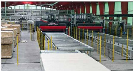
Auslauf eines ausgehärteten BSP-Elements aus einer der Pressen; jede der zwei Pressen gehört zu einem der beiden voneinander unabhängigen Fertigungsstränge, welche die Unempfindlichkeit der Produktion gegen Störungen (Redundanz) wesentlich erhöhen.
