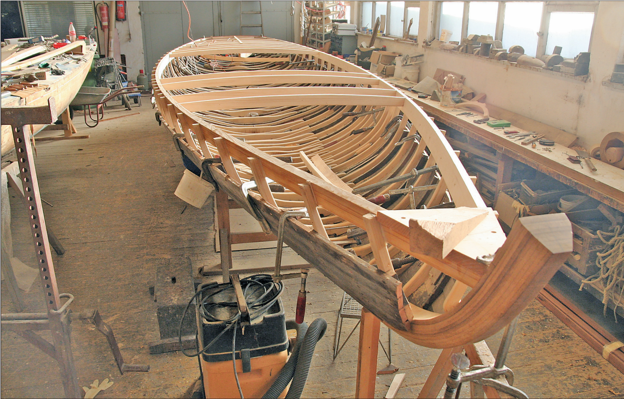
Bei diesem „L-Boot“ werden nahezu alle ursprünglichen Hölzer ersetzt. Während die neuen Spanten bereits eingesetzt wurden, sind die alten Planken noch vorhanden. Fotos: Stephan Klein
