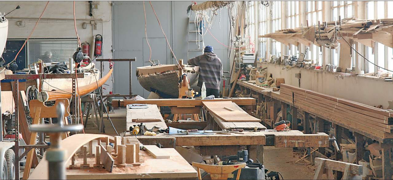
Der nähere Blick in die Holzwerkstatt der Michelsen-Werft zeigt eine Vielzahl von Hölzern, die in alle möglichen Formen verleimt, geschäftet, gesägt und gehobelt werden.
