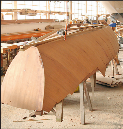
Mancher Schiffsrumpf wird aus kreuzweise verleimten Furnierlagen hergestellt – eine aufwändige, aber auch Gewicht sparende Bauweise.
