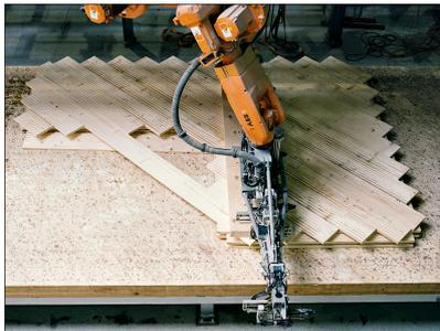
Die Brettlagen der Vollholzelemente werden sowohl kreuzweise als auch diagonal zueinander verlegt und von Robotern mit Holzdübeln untereinander verbunden.
