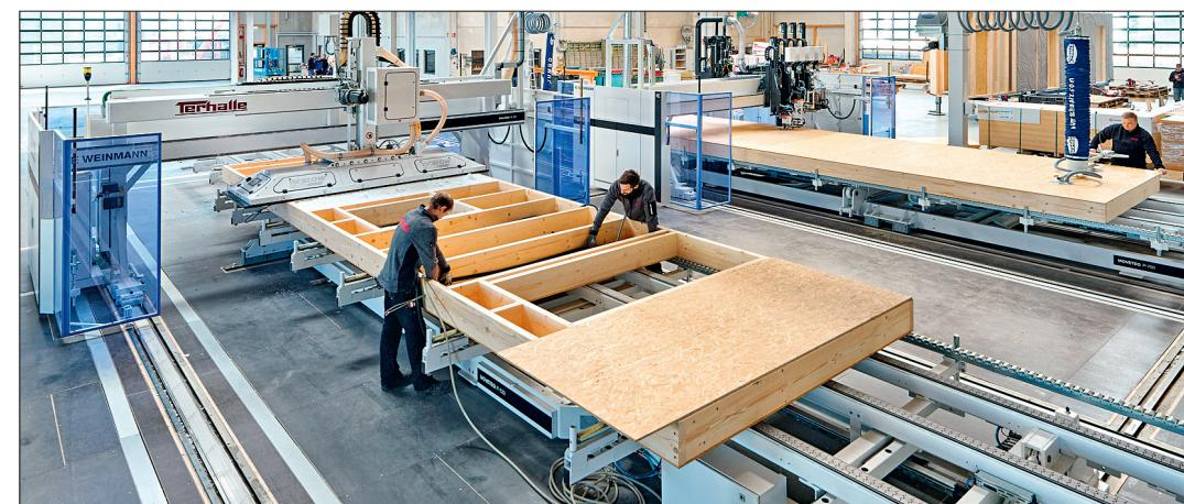
Blick in die neue Holzrahmenbau-Halle mit einer Multifunktionsbrücke „Wallteq M-380“ und einer „Wallteq M-380 Insufill“, die mit einer Einblasplatte versehen als reine Dämmstation genutzt wird.
