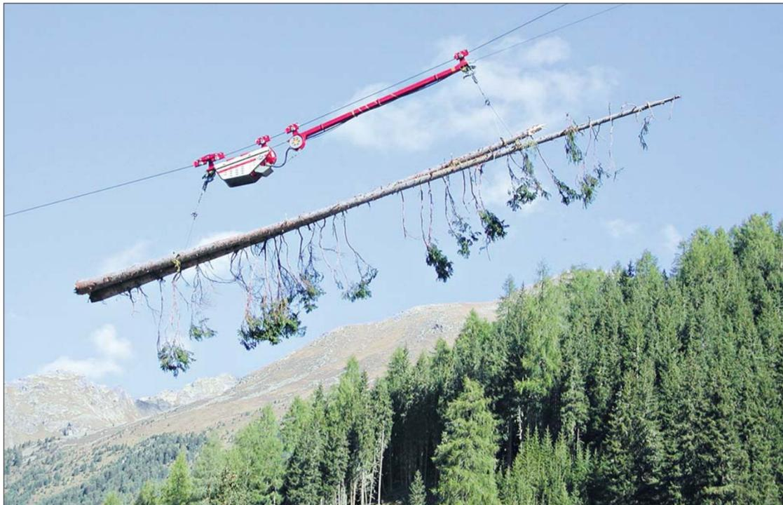
Die Holzbringung mittels Seilkransystemen nimmt in den Alpen immer mehr zu. Dieser motorisierte Laufwagen der Firma Seik hebt bis zu 2 t im Einzelzug und im hier gezeigten Doppelzug (mit rotem Waagbalken) bis zu 4 t.
