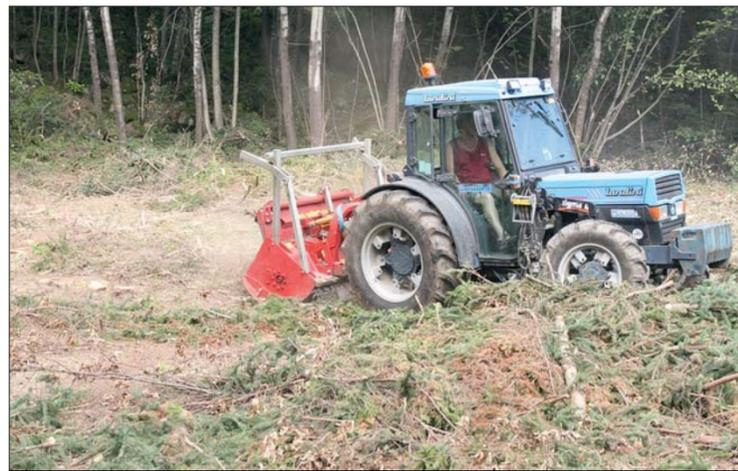
Ein spezielles Mulchgerät für Waldböden der Firma Seppi M. bei der Aufbereitung eines kürzlich gerodeten Fichtenbestandes.
