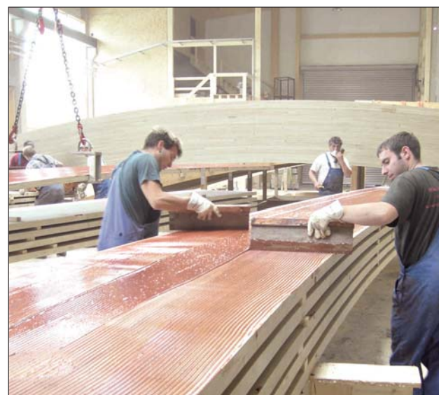
Leimauftrag auf die acetylierten Lamellen aus neuseeländischer Kiefer.
