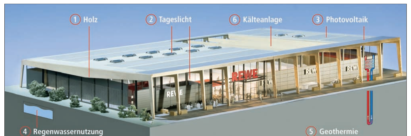
Moderner Gewerbebau mit Holz als Konstruktionsmaterial, außerdem mit Photovoltaik, der Nutzung von Regenwasser und Tageslicht, einer energieeffizienten Kühlung sowie Erdwärme zur Beheizung.
