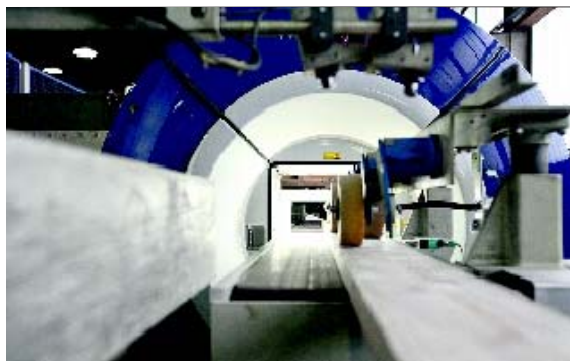
Das Holz wird im ersten Produktionsschritt mit zwei Scannern unter Berücksichtigung der optischen und festigkeitsrelevanten Eigenschaften vorsortiert.
