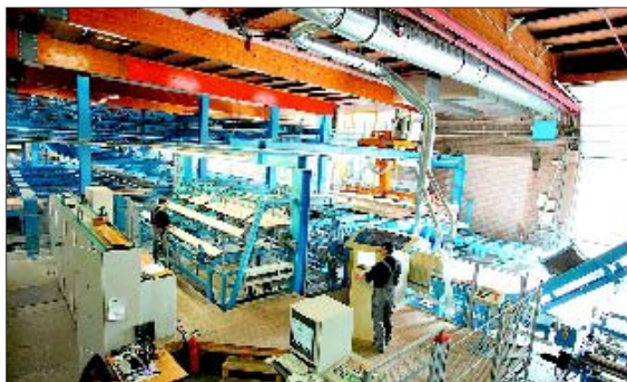
Mit der neuen Keilzinkenanlage lassen sich täglich etwa 80 m 3 Brettschichtholz, Duo- und Trio-Balken pro Schicht fahren.
