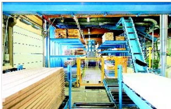
Die sortierten Bretter werden in einem automatischen Lagersystem zwischengelagert, das der Keilzinkenanlage das Holz bedarfsgerecht zuführt.
