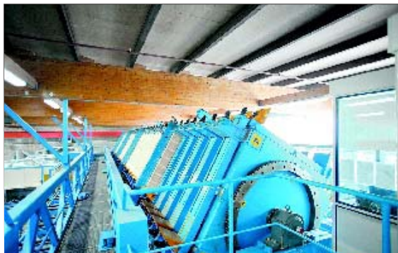
Alle vier Pressbetten des Verleimsterns können mit unterschiedlichen Längen und Querschnitten sowie Abtreppungen von vier bis 18 m befüllt werden.
