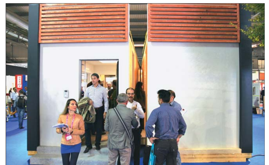
Das Projekt „Living-Box“ stellt eine komplett vorgefertigte Wohneinheit aus Brettsperrholz dar, die in einen einzigen Container passt und auf der Messe große Beachtung fand.
