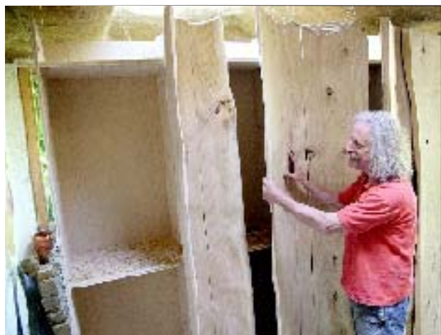
Ein solider Korpus aus Dreischichtplatten und spezielle Beschläge tragen diese massiven und schweren Laubholz-Schranktüren. Fotos: Nebelwasser (4), Klein (3)
