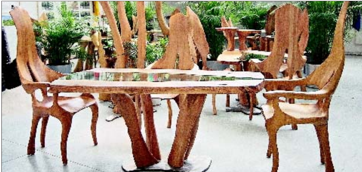
Aus möglichst einer einzigen hochwertigen Laubholzbohle wird der Lehnstuhl „Feli“ gefertigt, dessen individuelle und „organische“ Konturen mit einer Flexmaschine samt „Woodcarver“-Scheibe aus dem Holz gearbeitet werden.
