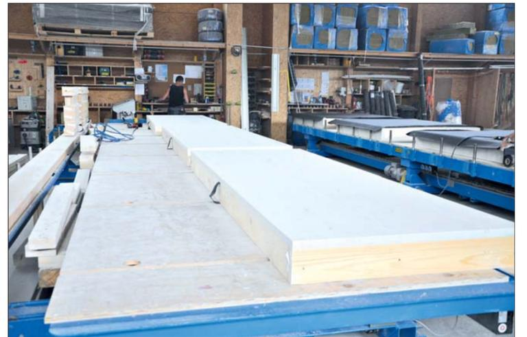
Vorgefertigte Fassadenelemente mit werksseitig aufgetragenen drei Lagen Gipsfaserplatte
