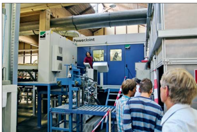
Die Kapazität der BSH-Produktion von Hess Timber wurde Anfang dieses Jahres u. a. durch eine neue „Powerjoint“-Keilzinkenanlage erhöht.
