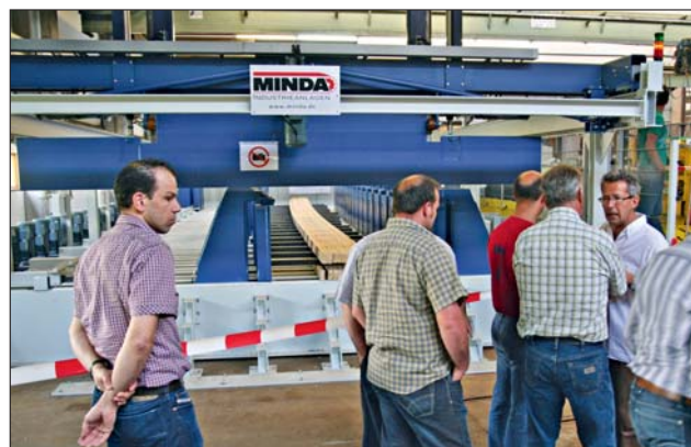
Beim Rundgang durch die Produktion wurde die neue CNC-gesteuerte Bogenbinderpresse vorgeführt, mit der sich kurze BSH-Bauteile sehr wirtschaftlich herstellen lassen.
