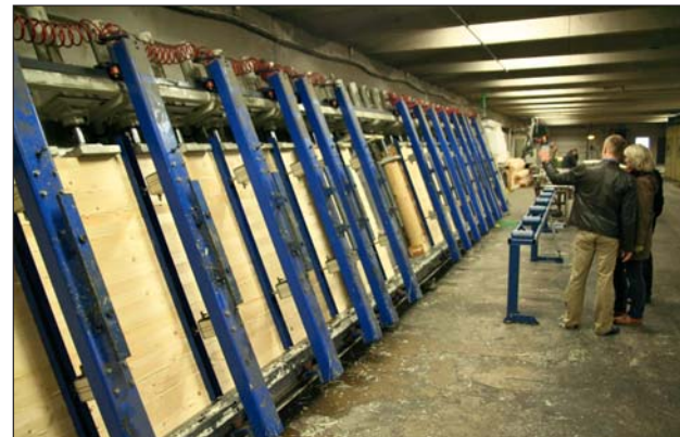
Produktion von Leimholz bei Palmatin vor allem für dickwandige Lamellenbalken bis 300 mm
