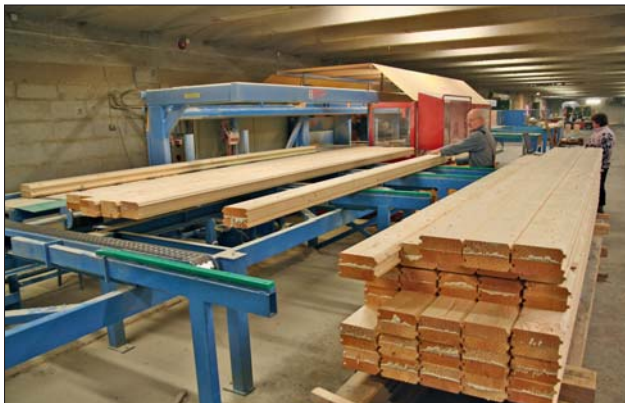
Abbund technisch getrockneter Blockbohlen bei Palmatin auf einer „Hundegger K2“.
