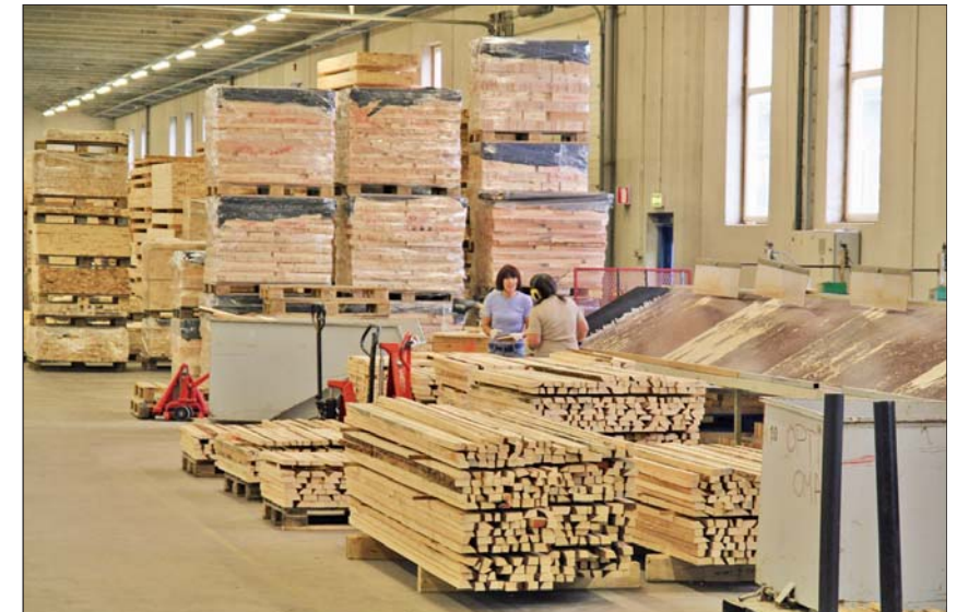
Vorsortierung der Hölzer bei der Aru grupp AS, bevor es in die Fensterkantenproduktion geht.
