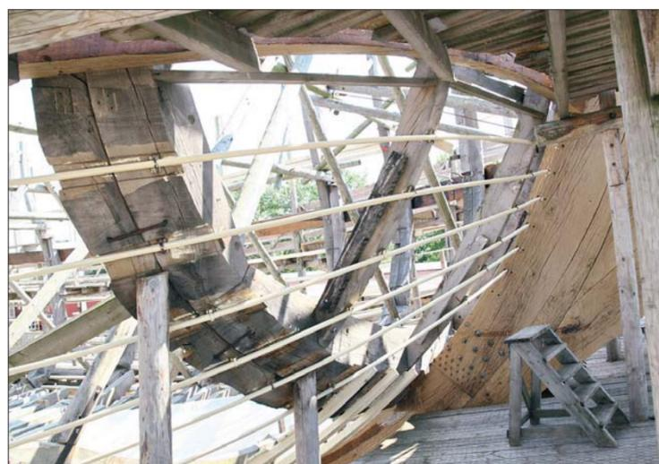
Am Bug der „Sieben Provinzen“ findet sich der mächtige Vorsteven (rechts im Bild, über der Treppe), der den Rumpf des Holzschiffes nach vorne hin abschließt; links im Bild die erste von 72 Spanten, deren Fertigung höchstes Können erfordert.
