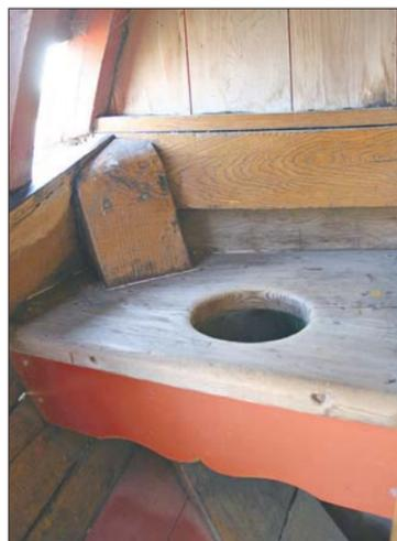
Toilette für die Offiziere und höhergestellte Mitreisende, die von der Kajüte am Heck des Schiffes erreichbar wie ein Schwalbennest über dem Wasser hängt.
